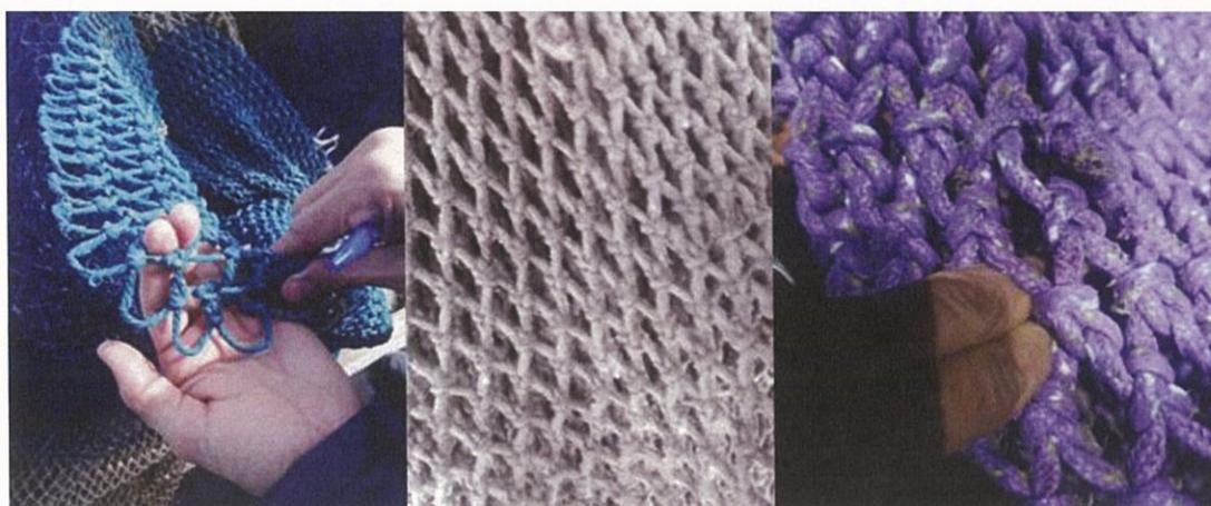
Figure 66: Photos de culs d'un chalut avec un maillage de 25 à 30 mm de maille étirée prises lors des enquêtes de terrain et des embarquements à bord des chalutiers du port de Larache
