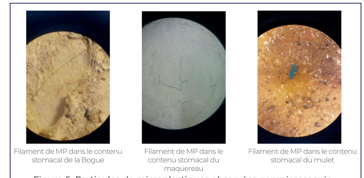
Figure 6. Particules de microplastiques observées par microscopie.
